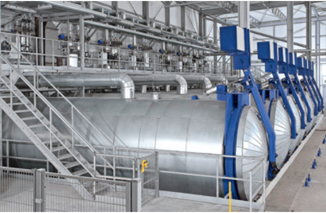
Автоклавы с автоматическим управлением
