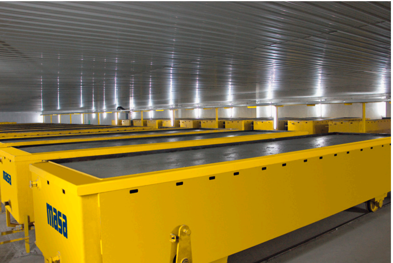
Формы в зоне ферментации
