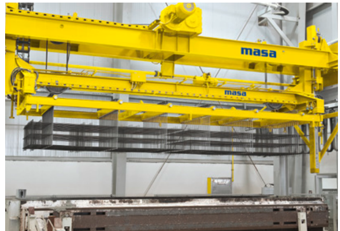
Кран-манипулятор для установки арматурных каркасов в форму
