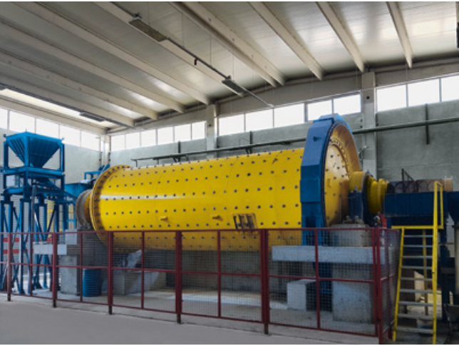
Помол кварцевого песка в шаровой мельнице мокрого помола
