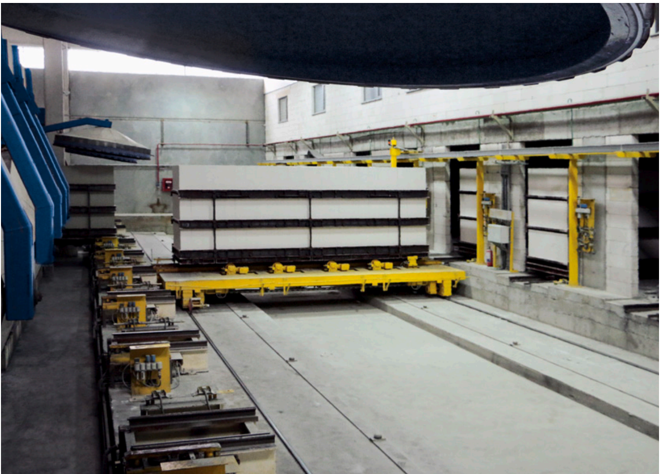
Загрузка автоклавов: блоки подаются на тележках в автоклавы для запаривания
