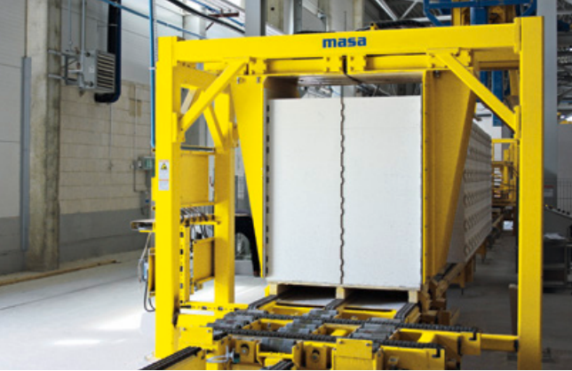
Станция уплотнения пакетов изделий
