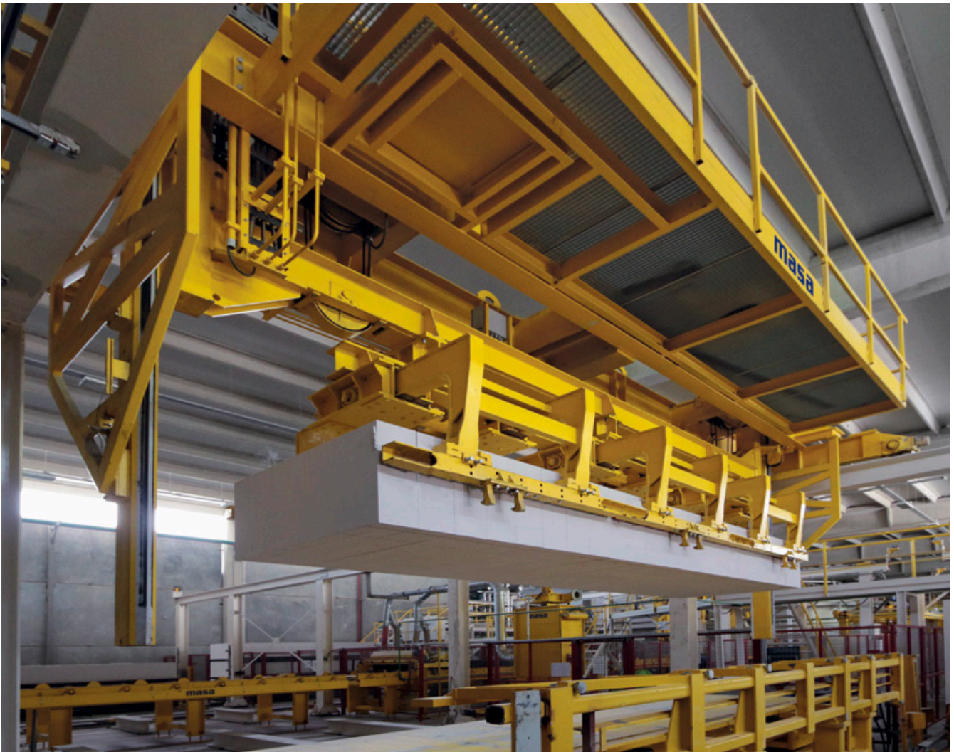
После автоклавирувания: подача запаренного массива на линию упаковки
